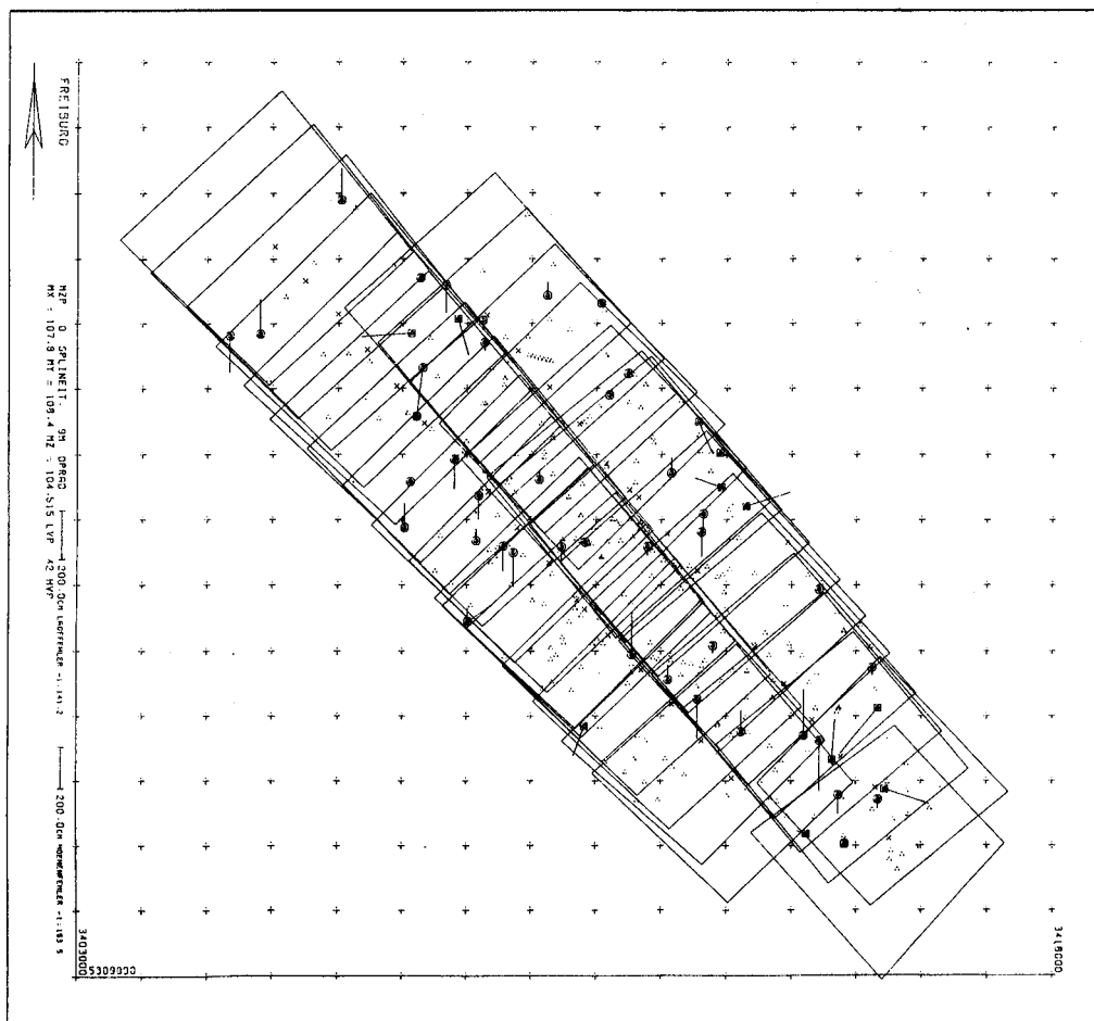
Abb.2: Plot des Bildverbandes, der Paßpunkte und Neupunkte sowie der Restfehlervektoren der simultanen RMK-Befliegung des Testfeldes Freiburg
